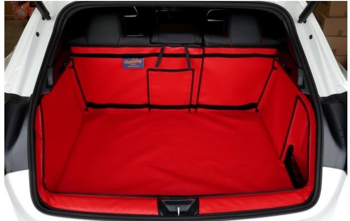
Bild oben zeigt die Kofferraumauskleidung mit der Rücksitze in der aufrecht Position mit Skidurchreiche.
